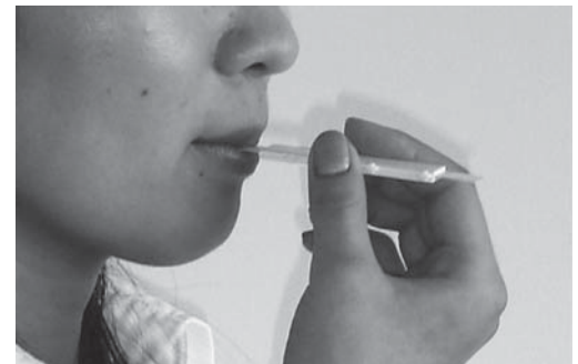
(b) テストストリップを口腔に挿入すると約30秒で唾液が採取できる
