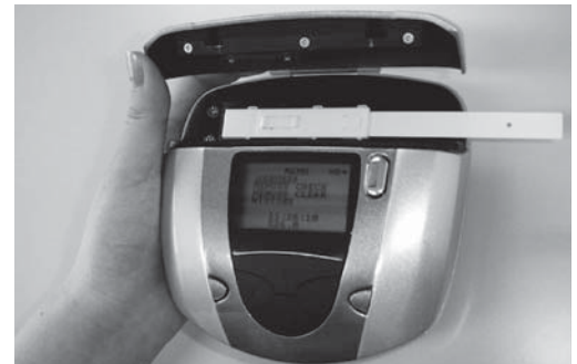
(a) 本体に装着した使い捨て式のテストストリップ (110 × 100 × 40 mm 3 , 350 g)
