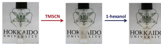
図 2. シリルエーテル化反応に誘起される高分子 PU の相分離 (透過度測定によるモニタリング).
