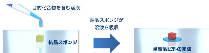
図 1 結晶スポンジ法における構造解析用試料の作成
